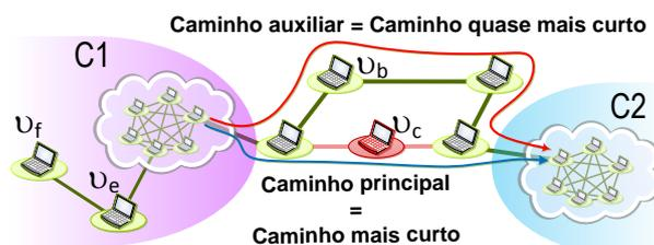
**Figura 1. Exemplo de topologia de rede na qual as métricas típicas de centralidade de intermediação podem falhar quando tentam capturar a importância de nós críticos que participam mais de caminhos quase mais curtos. As nuvens representam qualquer tipo de topologia de rede conectada.**
