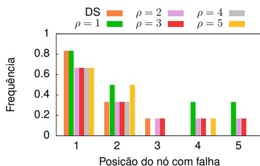
**Figura 6. Os nós classificados na primeira posição frequentemente são os mesmos em relação ao ranqueamento da intermediação tradicional, considerando-se todas as amostras tomadas do conjunto de dados de TAPASCologne, enquanto nas posições seguintes essa frequência diminui consideravelmente.**
