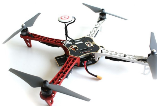
Figura 3. VANT utilizado nos testes de voo, com carga paga de 1.2 kg.
