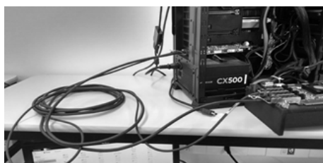
(a) Conexão da aceleradora com comutador KeyFlow.
